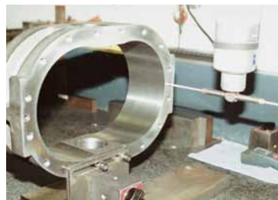
A — Mensuração coordenada (exibição da série Legend)
